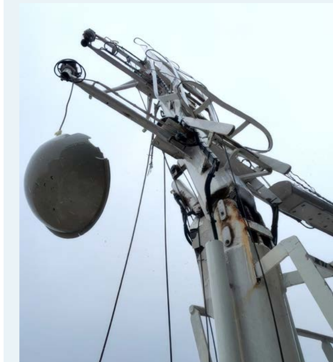
▼ Figuur 26: Schade aan achtermast Eikborg. (bron: Wagenborg)
