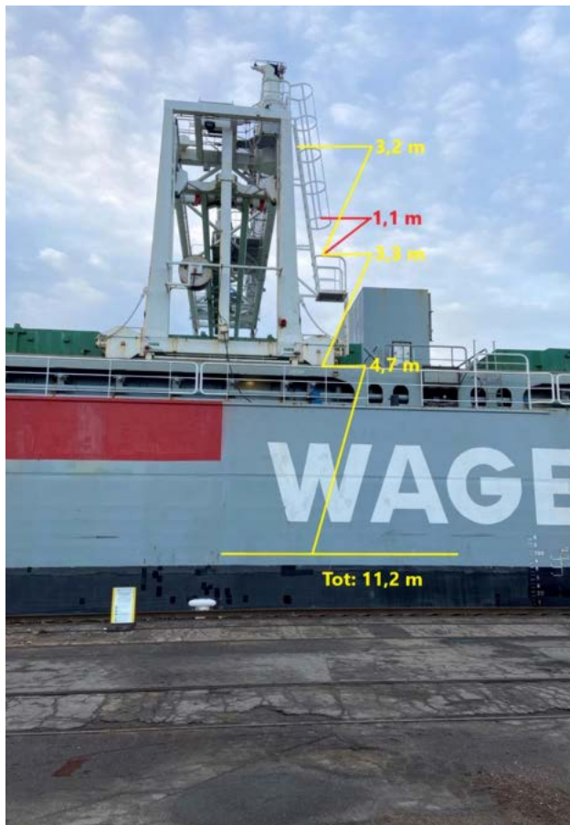
◀ Figuur 11: De figuur laat zien hoe de persoon op de kade viel. Gele lijnen en cijfers geven de hoogtes aan van de verschillende fases van de val. Rode cijfers en lijnen markeren de opening tussen de beschermkooi van de ladder en de reling op het smalle platform. De foto is bij een andere gelegenheid genomen toen het schip een andere diepgang had. De onderste gele horizontale lijn geeft de hoogte van de kade aan, ten tijde van het ongeval. (Bron: Statens Haverikommision)
