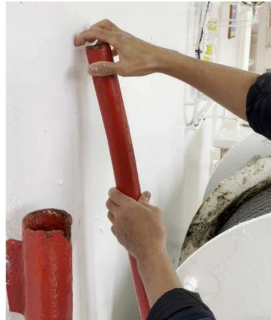
▲ Figuur 32: Simulatie van het bedienen van de lier. Tijdens het ongeval droeg het bemanningslid wel handschoenen. (Bron: HAL)
