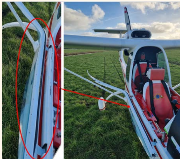
▲ Figuur 1: Het vliegtuig na de noodlanding. Een klein deel van de canopy zat nog vast aan het vliegtuig door middel van het scharnier.
