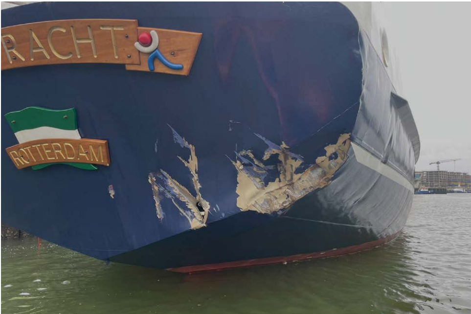
◀ Figuur 21: Schade aan de spiegel van het schip. (Bron: STC Eendracht)
