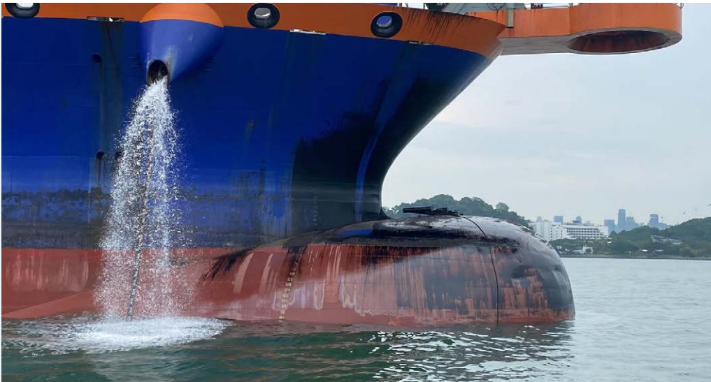
▲ Figuur 18: Zware stookolie en een stuk van het hekwerk bleven na de aanvaring achter op de bulb van het baggerschip. (Bron: Transportation Safety Investigations Bureau (TSIB))
