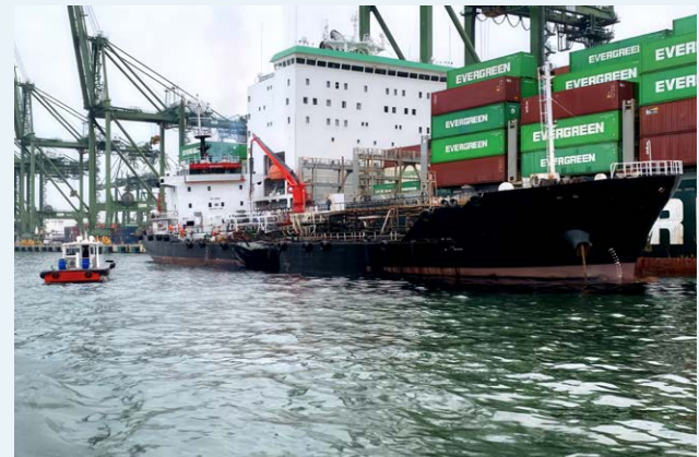
▲ Figuur 19: Het bunkerschip met in het midden het gat dat ontstond door de aanvaring. (Bron: Transportation Safety Investigations Bureau (TSIB))
