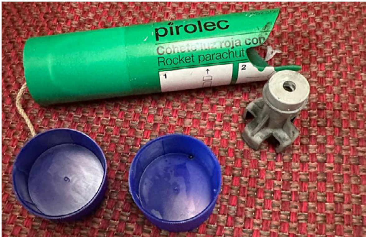
▲ Figuur 5: Veiliggestelde restanten van de geëxplodeerde flare, 1 januari 2023. (Bron: Bontekoning)
