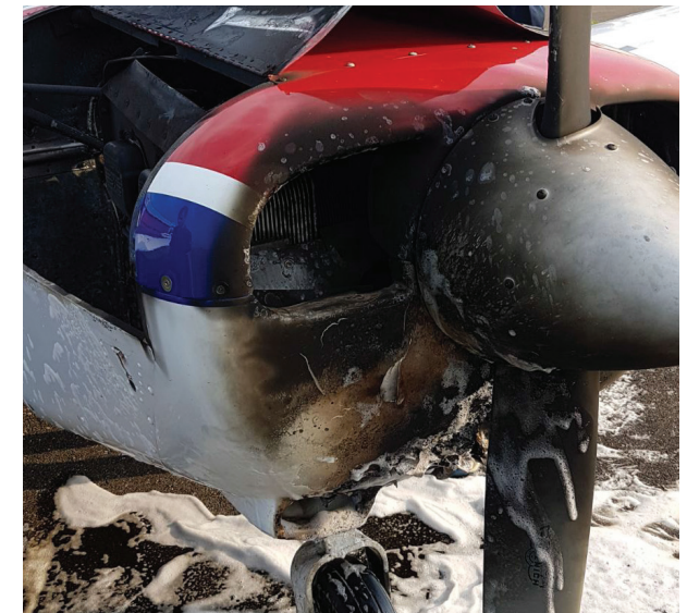
De schade aan de G-BJSV kort na het blussen van de brand. (Foto: Vliegclub)
