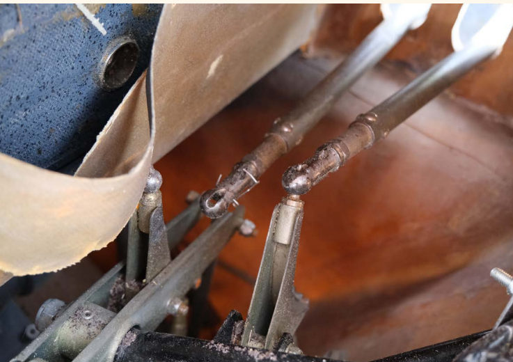
▲ De aangetroffen L'Hotellierkoppelingen van de rechter flaperon (niet aangesloten toestand) en de rechterremklep (aangesloten toestand).
