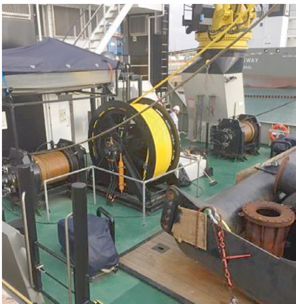
De trommel met de umbilical kabel (geel) aan boord van de Terra Plana. (Foto: BosKalis)
