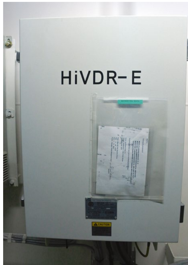
VDR-apparatuur aan boord van een zeeschip.
