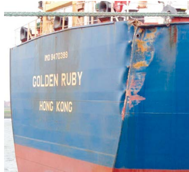
Deuk in het achterschip van de Golden Ruby. (Foto: Inspectie Leefomgeving en Transport)
