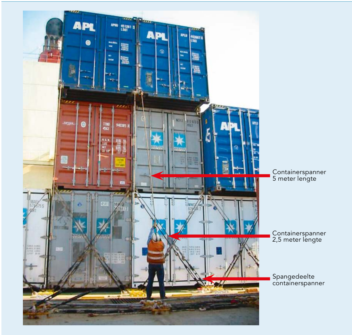
Havenwerker bevestigt een 5 meter lange containerspanner. (Foto: www.portpictures.nl - Danny Cornelissen)
