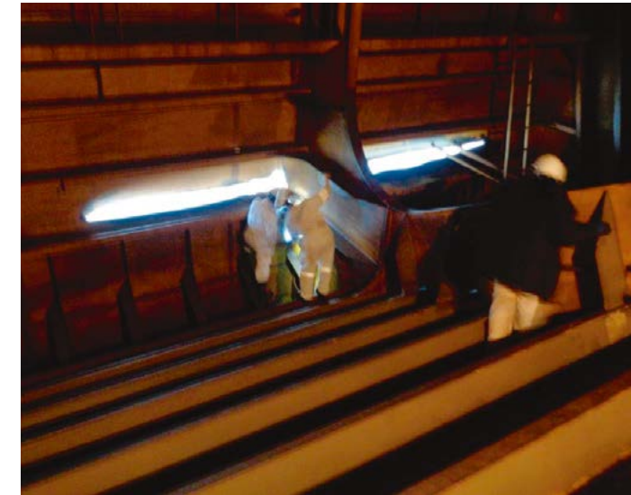
Gat in het achterschip van de Frontier Island. (Foto: Inspectie Leefomgeving en Transport)
