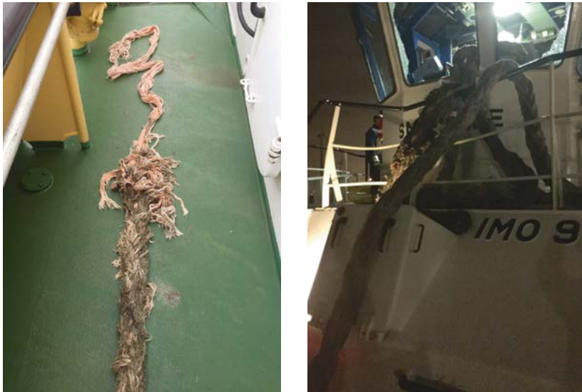
Geknapt sleepverbinding en schade aan schip. (Foto: Boskalis)
