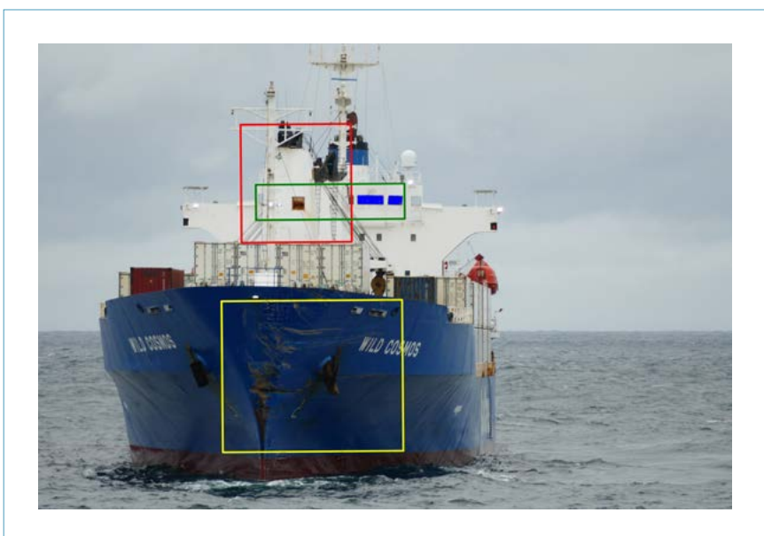
Figuur 11: Op deze foto is te zien dat de stuurboordsramen in het groene blok worden afgedekt door de kranen in het rode blok. (Bron: Danish Fisheries Inspection)
