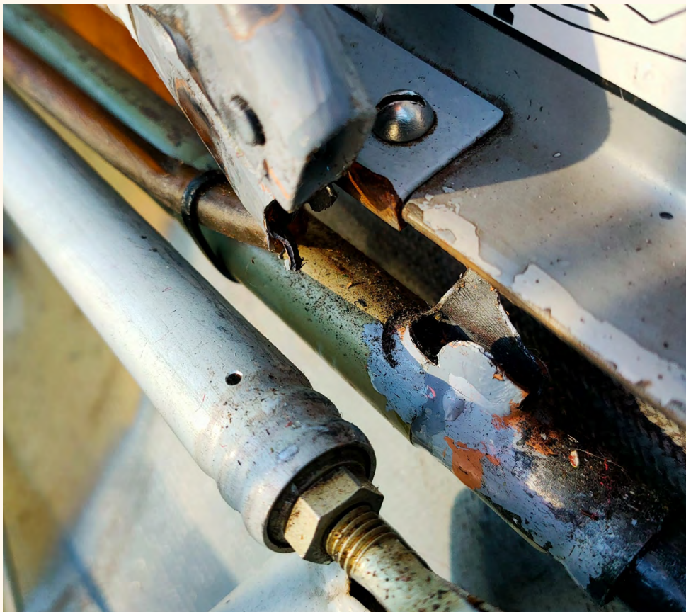
◀ De afgebroken remklephendel (Bron: zweefvliegclub)
