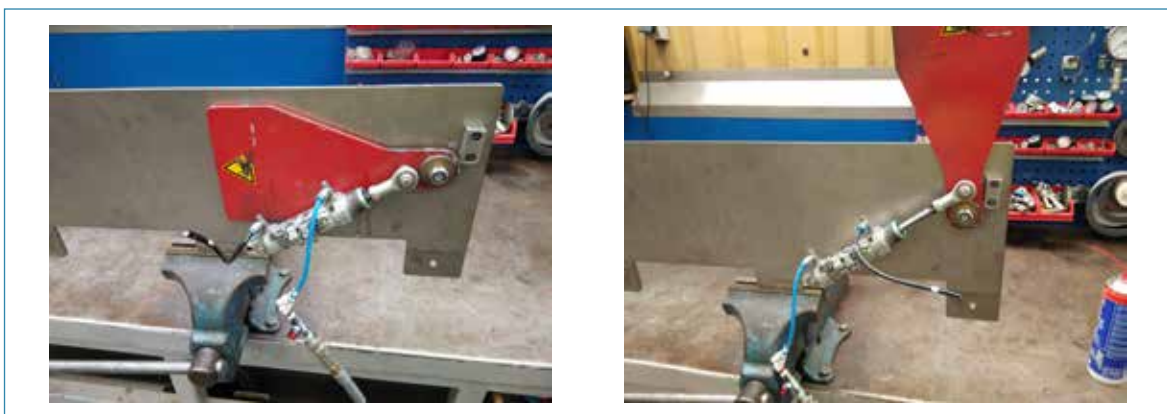
Figuur 6: foto van het stopbord (tijdens de testopstelling na het voorval het rode van links in de neer-stand en rechts in de omhoog-stand. (Bron: Nederlandse Arbeidsinspectie).
