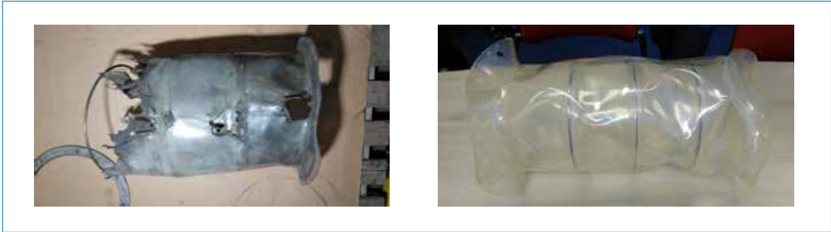
Figuur 4: Foto's van de manchet (links het gesmolten manchet, rechts een nieuw exemplaar. Bron: Nederlandse Arbeidsinspectie).
