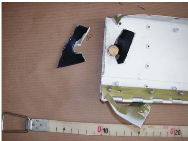
Figuur 13: bezwaken achterste bevestigingspunt van de rechtervleugel met de achterligger
