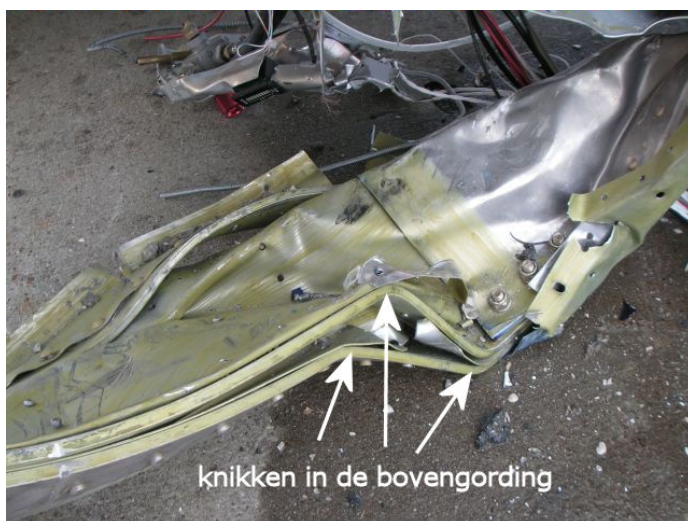
Figuur 7: geknikte hoofdligger van de rechternleugel
