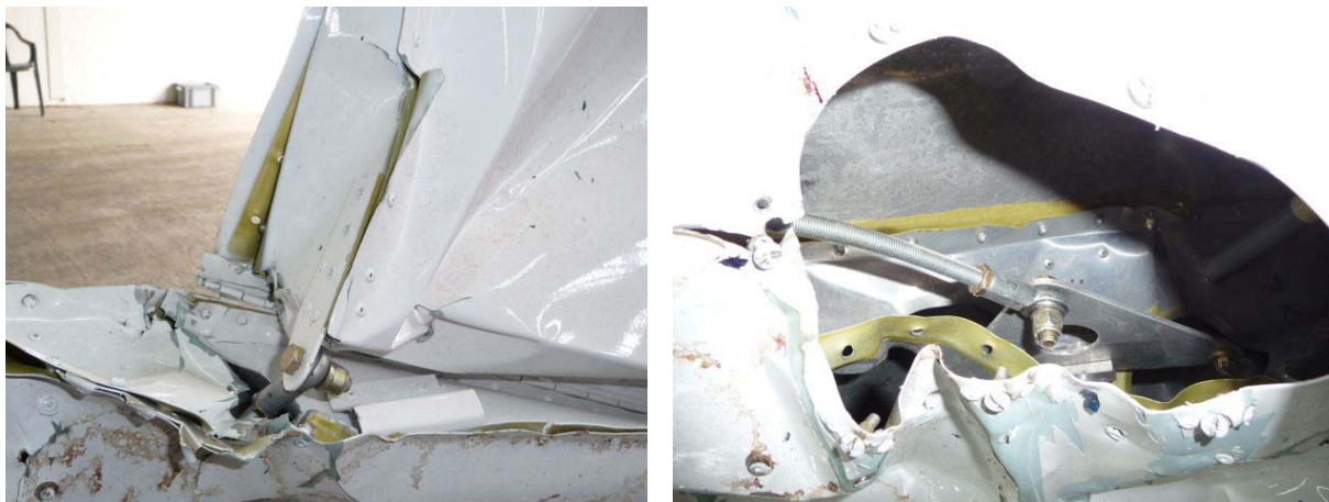
Figuur 10: beschadigingen van de rechter rolroeraandrijving (buiten- en binnenzijde)
