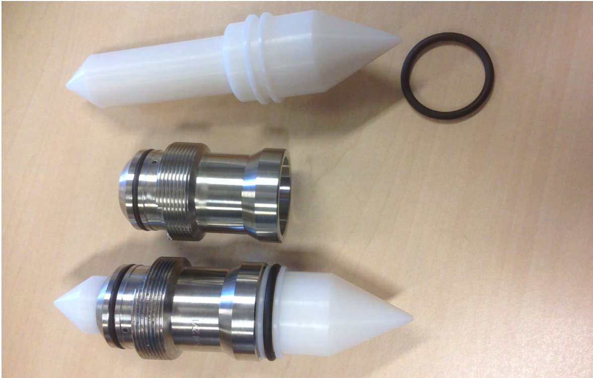
Figuur 3: Radarprobe van wit kunststof in de RVS zetting. De zwarte O-ringen sluiten de probe-flens verbinding gasdicht af. (Bron: Shin-Etsu)
