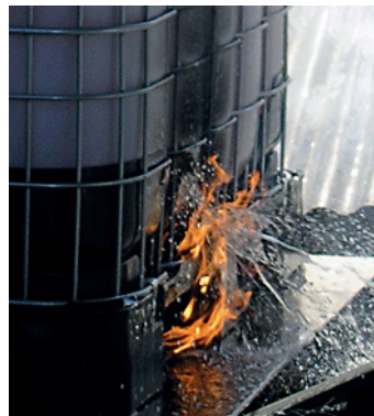
HSE test beperkte vuurlast (krantenprop) onder een IBC en het directe gevolg. (Bron: HSE rapport)
