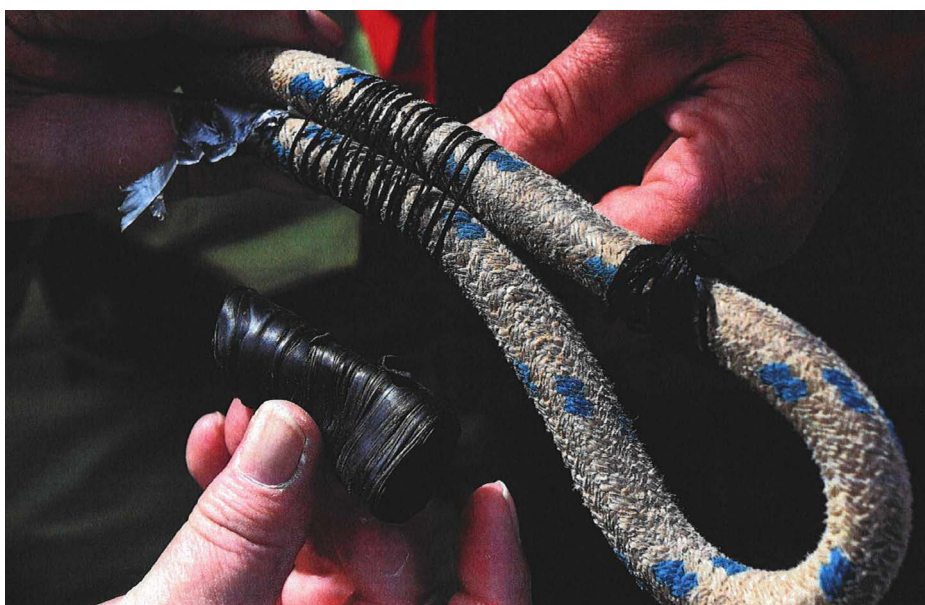
Figuur 12: De gebruikte kunststof kraanlijn met oog en een voorbeeld van het bindsel zoals hij aangebracht was. Dit beeld is ter illustratie en laat de relatief korte verbinding zien, de windingen liggen verder uiteen dan het oorspronkelijke bindsel. In de hand wordt de vulkaniserende tape gehouden die over het bindsel was aangebracht. (Bron: Maritieme Politie)
