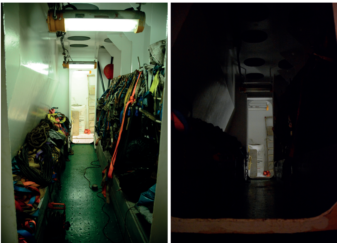
Figuur 6: Trappenhuis waar de laskabels lagen, met de verlichting in- / uitgeschakeld. Deze foto's zijn gemaakt tijdens het bezoek aan de Fortunagracht twee weken na het ongeval. De omstandigheden waren toen anders dan op de dag van het ongeval. De foto's geven daarom enkel een indicatie van het verschil tussen in- en uitgeschakelde verlichting.
