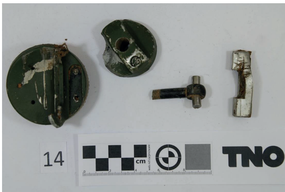
Figuur 10 Onderdelen afkomstig uit potje AABV5498NL, met stelknop van het commandovizier van de mortier (2 e onderdeel van links) 17 .
