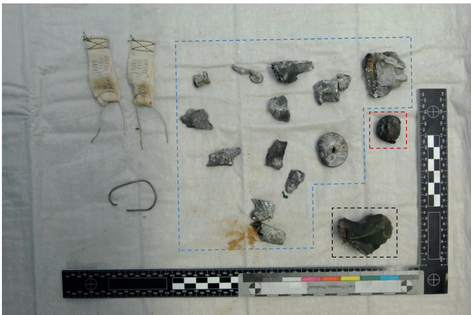
Figuur 5 Inhoud van de papieren zak: fragmenten van de mantel van de schokbuis, de slagpin en afsluitplaat (in blauw kader), verbindingstop van de granaat met de staart (rood kader) en deel van het commandovizier van de mortier (zwart kader). 10
