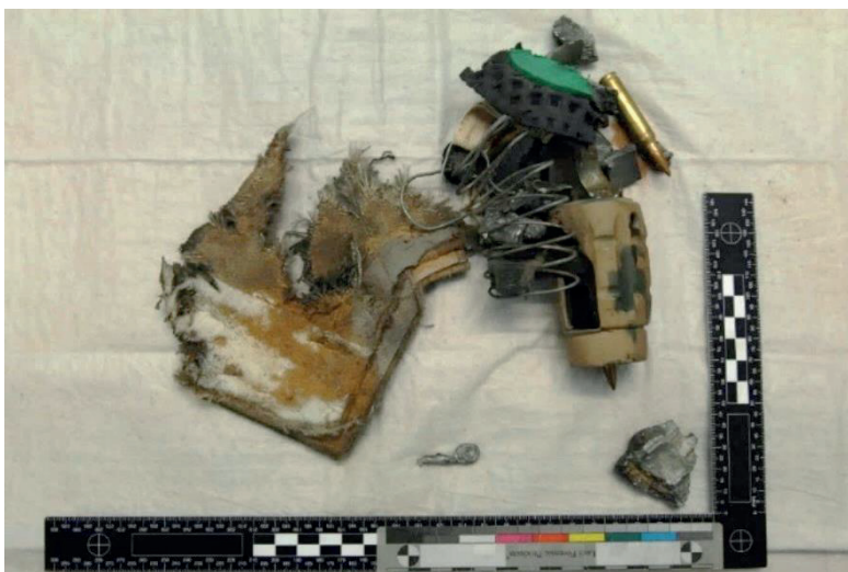
Figuur 3 Inhoud van de papieren zak: zichtbaar zijn fragmenten van een schokbuis, een deel van een schoen, patronen, een magazijnveer, (waarschijnlijk) beschermhoes van de mortier, lintjes van de transportveiligheid van de granaat en de rubberen beschermkap van het snelrichtvizier van een Colt geweer. 8
