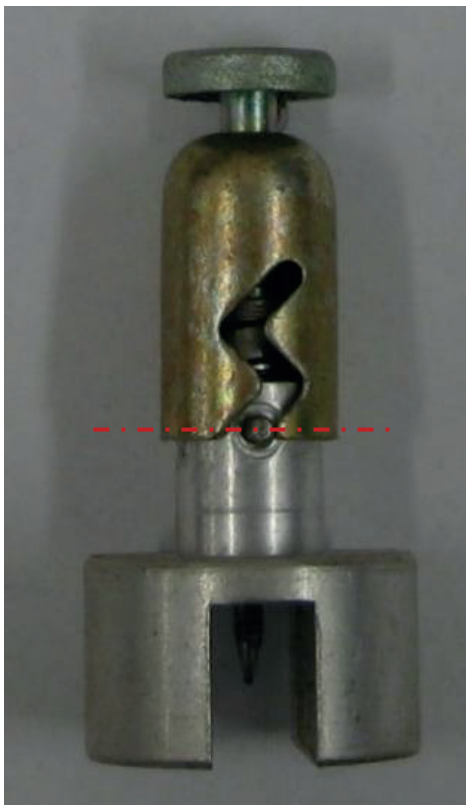
Figuur 15 Schokbuismechanisme samengesteld met correct gepositioneerde zigzag pin aan het begin van de eerste “knie” van de zigzag sleuf (foto uit 43 ).
