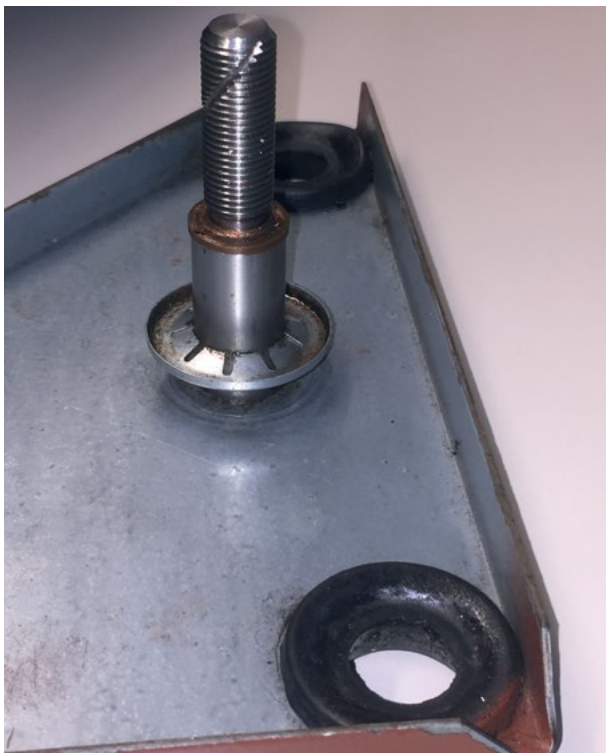
Omgekeerde veiligheidskap met Ontluchtingsbout. (Bron: Onderzoeksraad voor Veiligheid)
