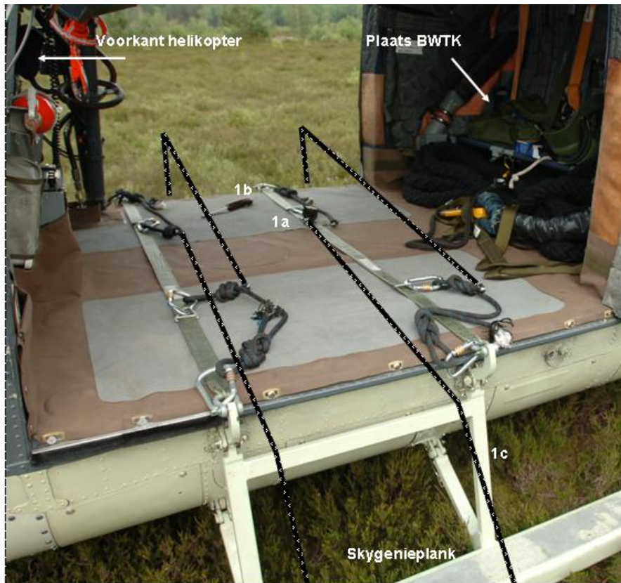
Afbeelding 6. De bevestiging van de afdaallijnen in de cabine (NB. Elke afdaallijn bestaat uit een stuk. De zwarte, wit gespikkelde, lijnen zijn niet de daadwerkelijke lijnen, maar zijn er ter verduidelijking ingetekend.)
