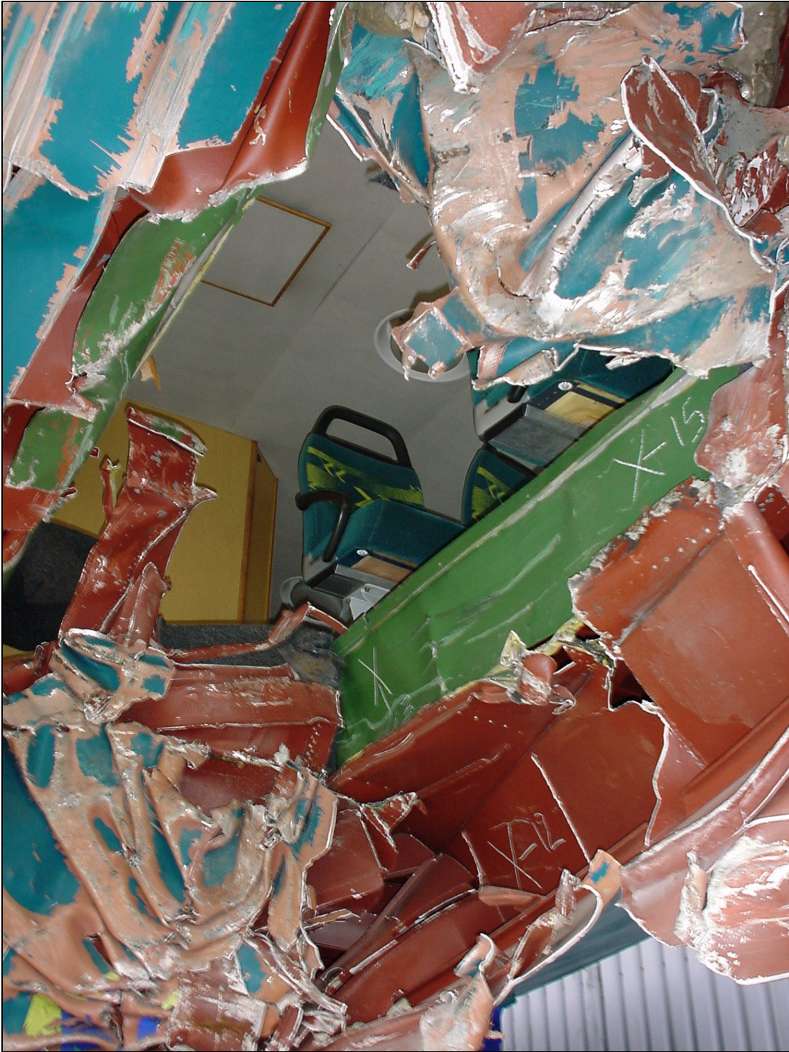
Figuur 5: Zicht op het voorste passagierscompartment van de Voskhod 605 door de opengereten scheepsromp.
