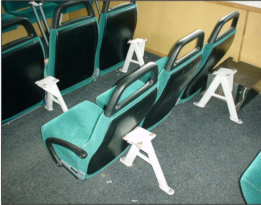
Figuur 6: Foto van afgebroken bevestigingen van passagiersstoelen
