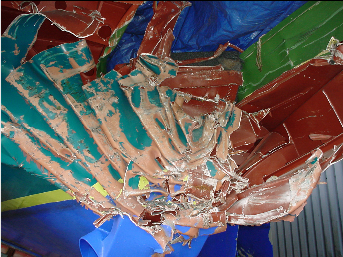
Figuur 4: Foto van de vervorming van de scheepsromp van de Voskhod 605 als gevolg van de uitgeoefende krachten tijdens de aanvaring.
