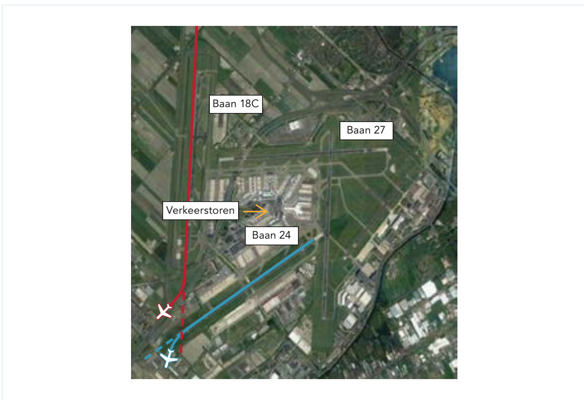
Figuur 1: Situatie om 19.56:26 uur, op basis van de radargegevens. Het rode vliegp pad is de doorstartende 737-700, het blauwe vliegp ad de startende 737-800. (Bron radar: LVNL)
