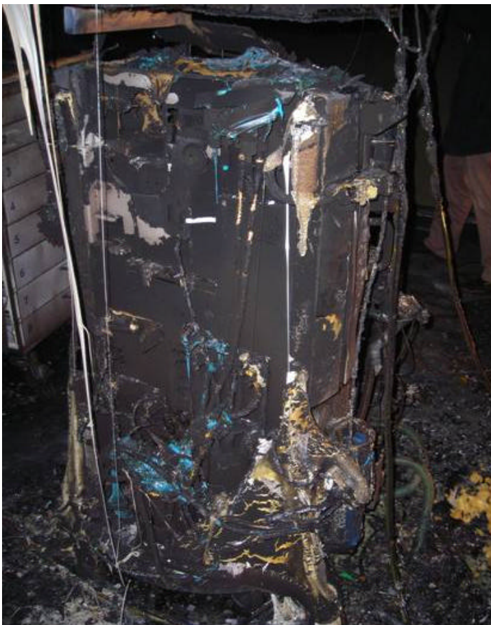
Figuur 18: Achterzijde anesthesietoestel. De kunststof omkasting van dit deel is sterk verbrand. Resten van de omkasting (blauw) en verbrande slangen liggen op de bodem van het toestel
