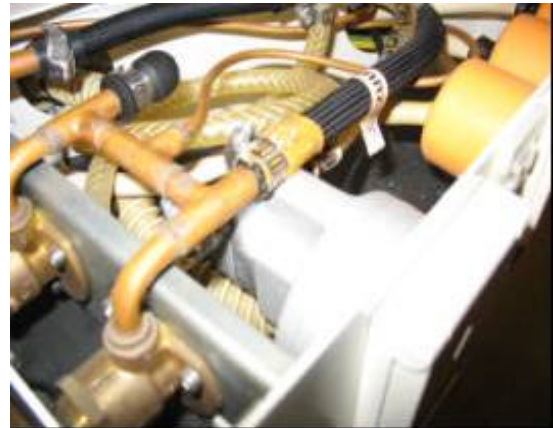
Figuur 6: Detail van de aanvoer van zuurstof in de pendel
