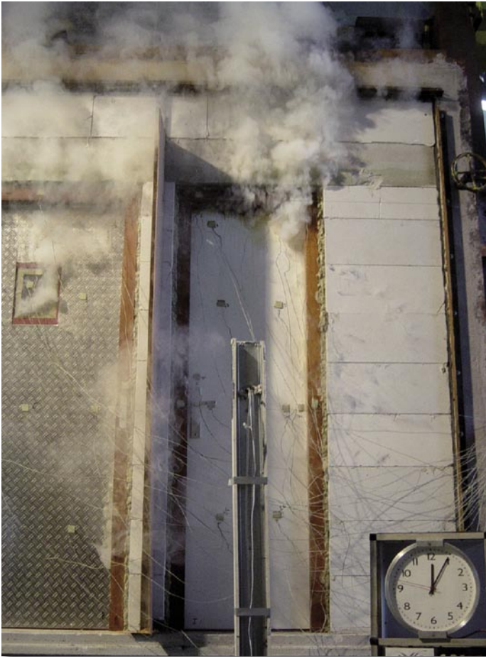
Figuur 23: Rookintreding in de cel tijdens de uitgevoerde brandweerstandproef op de celdeur
