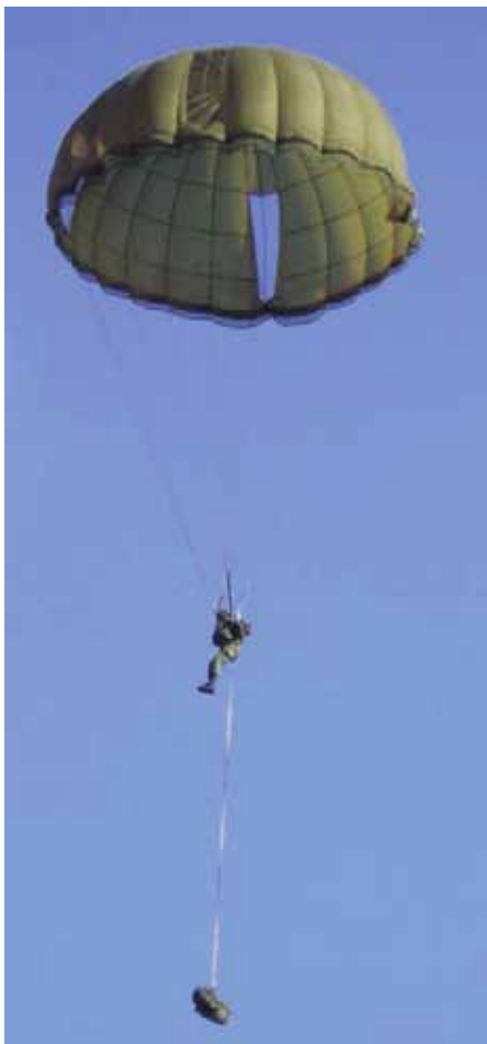
Afbeelding 2: Militair parachutist met ronde bol valscherf, type ARZ 696 MI
