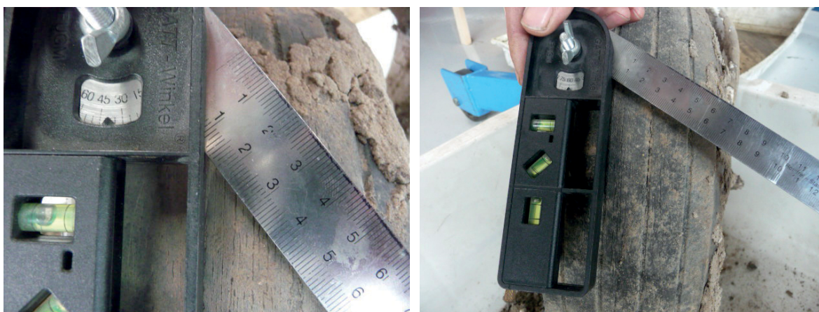
Figuur 3: 40 graden traverserende sporen (linkerfoto) tot 60 graden (rechterfoto) op de band van het neuswiel. (Bron: Onderzoeksraad voor Veiligheid)
