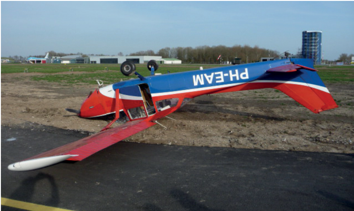
Figuur 1: De PH-EAM met afgebroken neuswiel naast de baan. (Bron: Onderzoeksraad voor Veiligheid)
