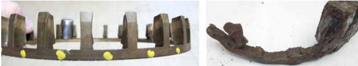
Figuur 21: Links een kam-vormige messing lagerkooi zoals gemonteerd in bewuste lagers; rechts de restanten van een van de twee lagerkooien uit het buitenste lager van de warmgelopen aspot (waarvan de koollippen zijn afgebroken).
