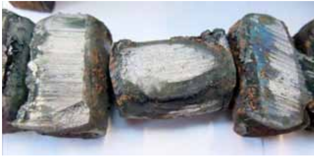
Figuur 20: Drie rollen uit het buitenste lager; één rol was een kwartslag gedraaid en aan alle drie waren platte kanten gesleten.
