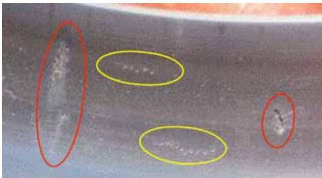
Figuur 22: De foto hiernaast toont de stroomdoorgang-beschadigingen (geel omcirkeld) en uitbrokkelingen (rood omcirkeld) in het loopvlak van de buitenring van een lager uit een van de andere tien onderzochte aspotten.
