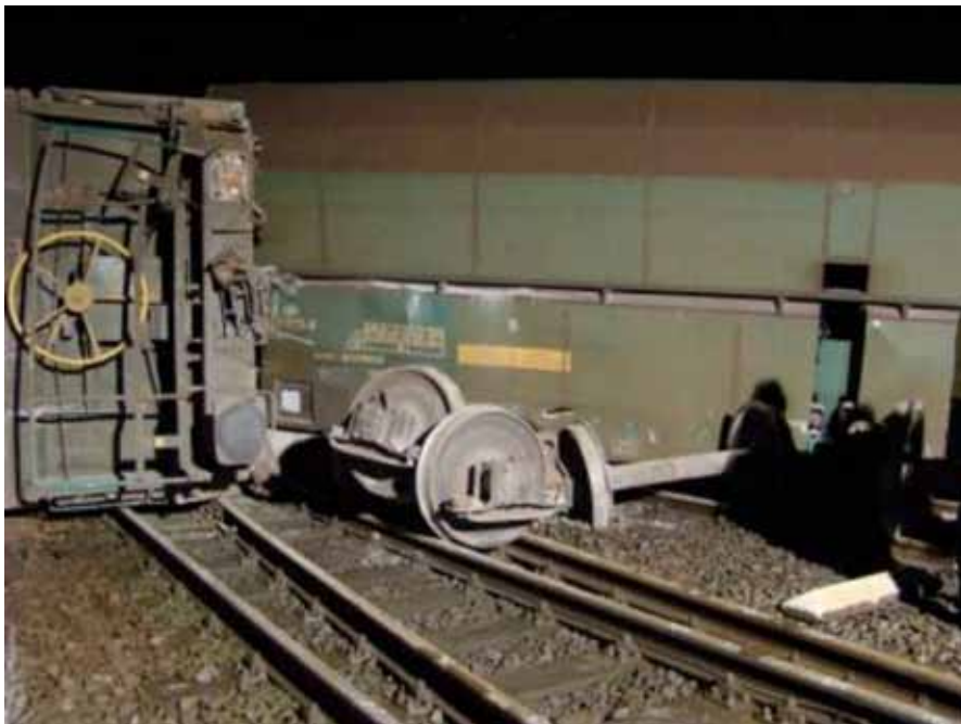
Figuur 16: Deze foto toont een deel van de ontspoorde wagons en enkele losgeraakte wielstellen.
