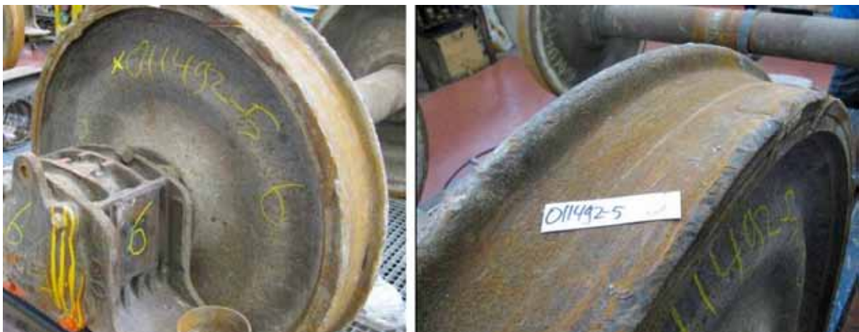
Figuur 14: Deze foto's tonen de beschadigingen die aan de wielen van het voorste wielstel (van het voorste draaistel van de elfde wagon) zijn ontstaan doordat het wielstel over de betonnen dwarsliggers heeft gelopen.
