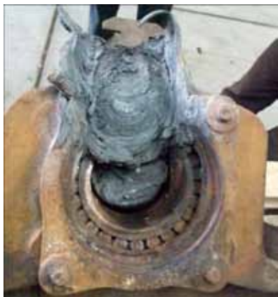
Figuur 24: Op deze foto van (de binnenzijde van) de warmgelopen aspot is te zien dat de astap zich in opwaartse richting door het aspothuis heeft gevreten.
