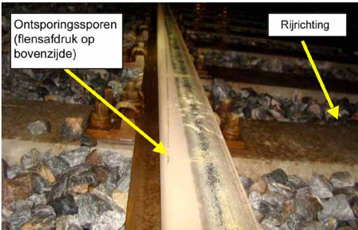
Figuur 12: Deze foto toont het ontsporingsspoor op de bovenzijde van de rechter spoorstaaf.
