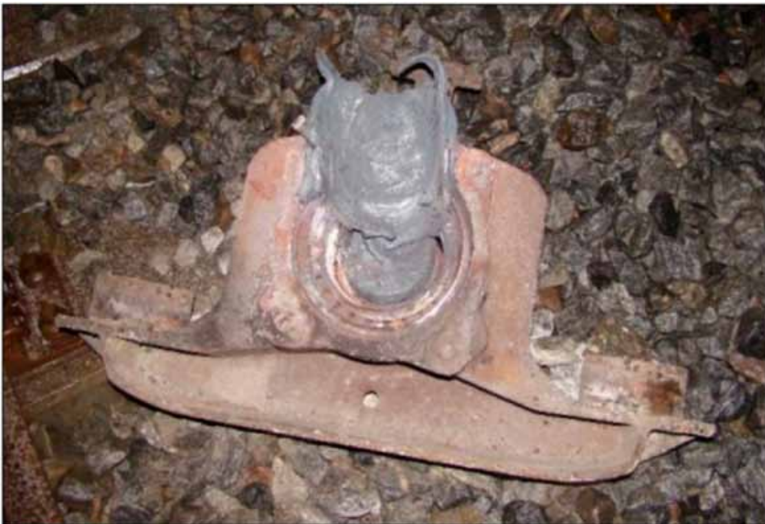
Figuur 9: De warmgelopen aspot, die ter hoogte van de ontspringsplaats werd aangetroffen naast het spoor.
