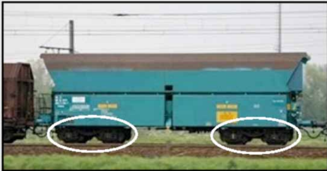
Figuur 6: Wagon, met twee draaistellen (met elk twee wielstellen).
