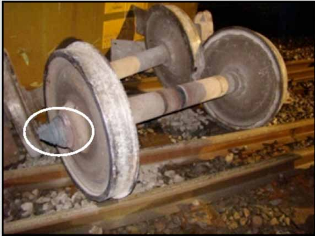
Figuur 8: Het tweede wielstel van de elfde wagon, waarvan de linker astap is afgebroken/gesmolten.
