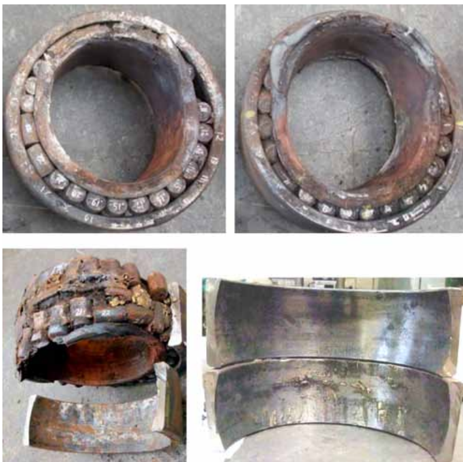
Figuur 19: Het buitenste lager uit de warmgelopen aspot. De foto linksboven toont de buitenkant, de foto rechtsboven de binnenkant. De foto linksonder is gemaakt nadat de buitenring was doorgezaagd en gedeeltelijk verwijderd. De foto rechtsonder toont het loopvlak van de buitenring, na te zijn schoongemaakt.
