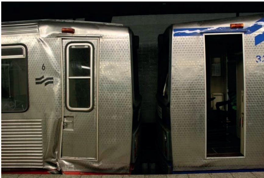
Figuur 4 Schade aan treinstel M006 van de aangereden metrotrein (links) en treinstel M032 van de botsende metrotrein (rechts) [bron: KLPD].
