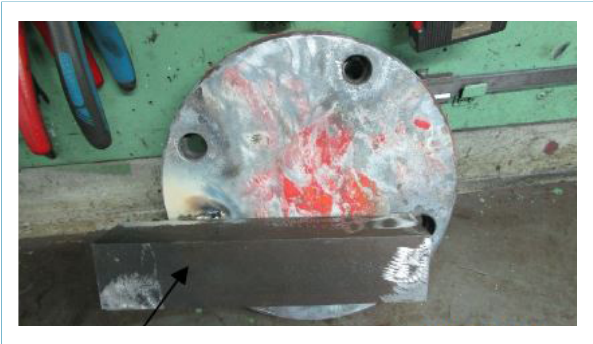
Figuur 8: De afdekplaat met een hoeklijn erop gelast als hulpmiddel om de dekplaat van het wiel te halen. (Bron: Holwerda Shipmanagement B.V.)
