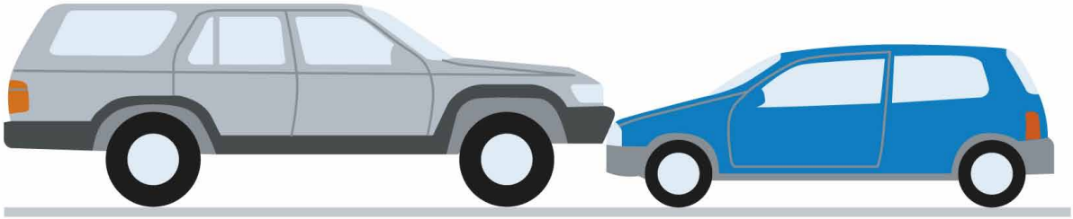
Figuur 33: Voorbeeld van geometrische incompatibiliteit in geval van een frontale botsing
