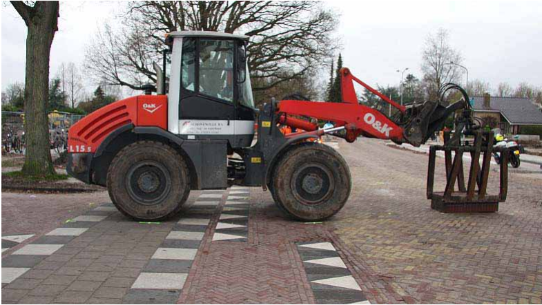
Figuur 7: De wiellader met de stenenklem in de Asserstraat voor het kruispunt met de Asserweg
