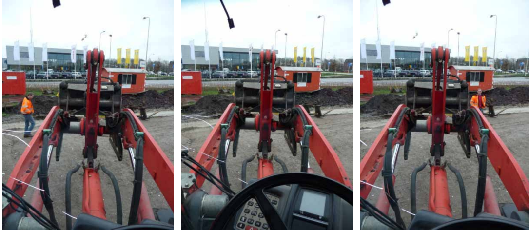
Figuur 29: Het directe zicht naar voren vanuit de wiellader. De voetganger die voorlangs loopt (in de oranje jas) is bij de middelste foto geheel achter de stenenklem verdwenen.
