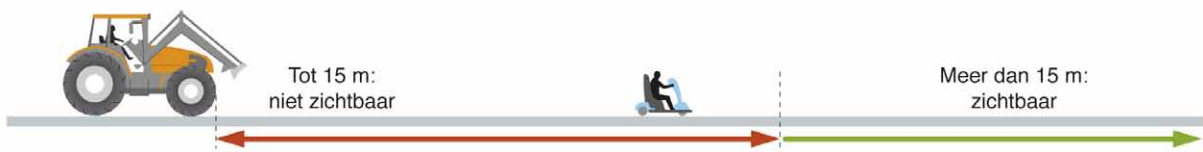
Figuur 21: Voor de bestuurder van de tractor was de scootmobiel niet zichtbaar wanneer deze zich minder dan 15 meter voor de tractor bevond
