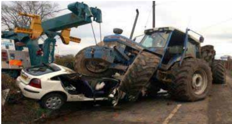
Figuur 34: Geometrische incompatibiliteit tussen (land)bouwvoertuig en personen auto 160
