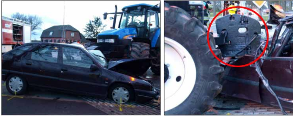
Figuur 24: De plaats van het ongeval bij Nunspeet met de personenauto en de tractor en de schade veroorzaakt door de contragewichten (in rode cirkel) aan de voorzijde van de tractor.
