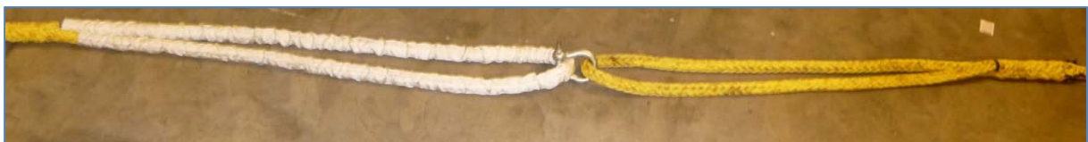
Figuur 4: Voorbeeld van een vergelijkbare trosverlenging, zoals gebruikt tijdens de afmeermanoeuvre
