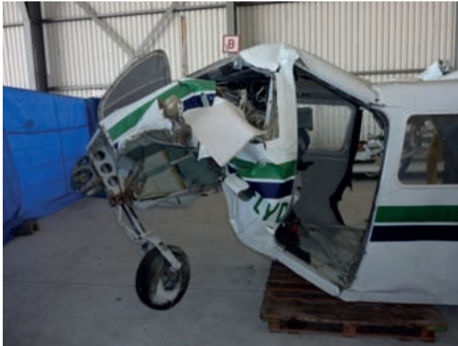
Figuur 5 en 6: zijaanzichten deformatie van de vliegtuigneus en de cockpit (stoelen verwijderd) Links: beschadiging vliegtuigneus, cockpitvloer omhoog geknikt Rechts: instrumentenpaneel tegen het dak
