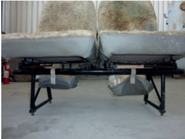
Figuur 8 en 9: voor- en zijaanzicht van de voorste rij stoelen met daaronder de niet-gebruikte reddingsvesten in de opbergzakken
