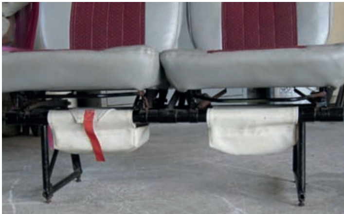
Figuur 10: uitbouwde stoelen met opbergzak met rode trekband in de normale conditie (links) en in niet-toegankelijke positie (rechts).
