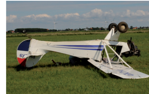
Avid AVID MARK IV over de kop geslagen (de motorkap is verwijderd)
