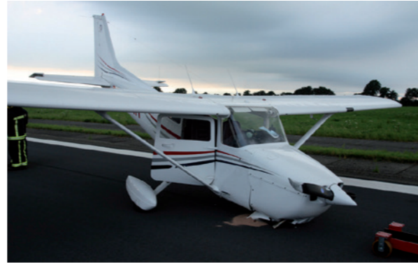
Reims F172P door neuswiel gezakt (bron: Rotterdam The Hague Airport)
