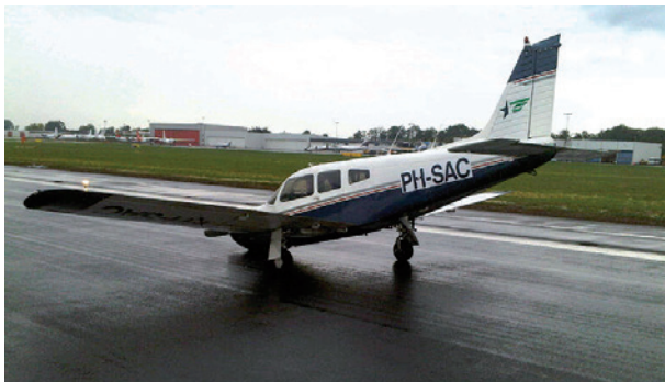
Piper PA-28R-201 na landing met ingeklapt neuswiel. Bron: Stella Aviation Academy
