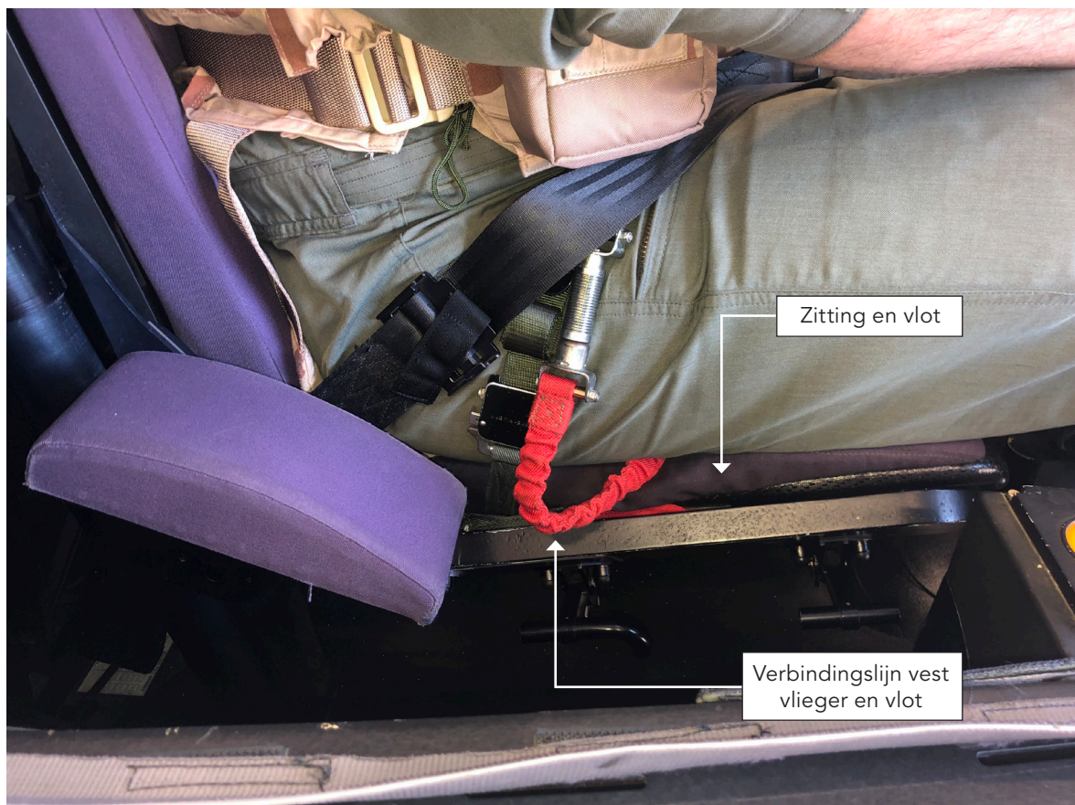
Figuur 7: Voorbeeld van de zitpositie van de vlieger op de zitting en het vlot met de verbindingslijn. (Bron: Onderzoeksraad voor Veiligheid)
