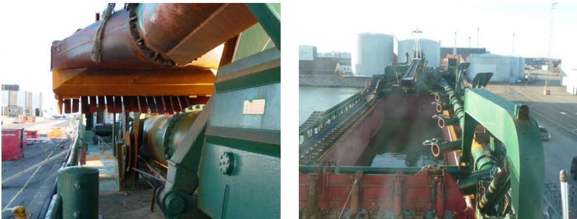
Figuur 3: Zuigkap (links) en laadruim met laadpijp (rechts).
