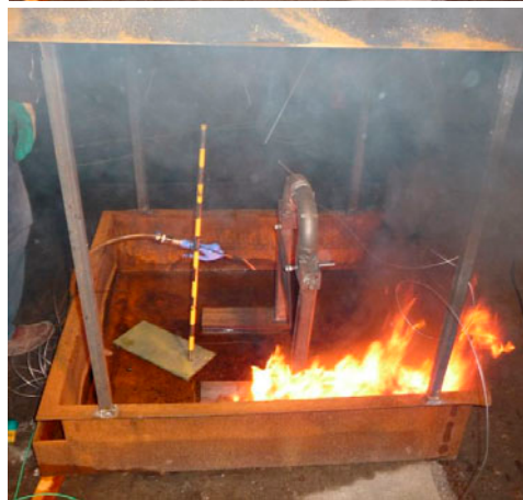
Figuur 9: Verloop van de ontsteking: foto's (a) van de situatie ca. 1 minuut voor ontsteking, (b) net na ontsteking en (c) ca. 10 s na ontsteking in test 5
