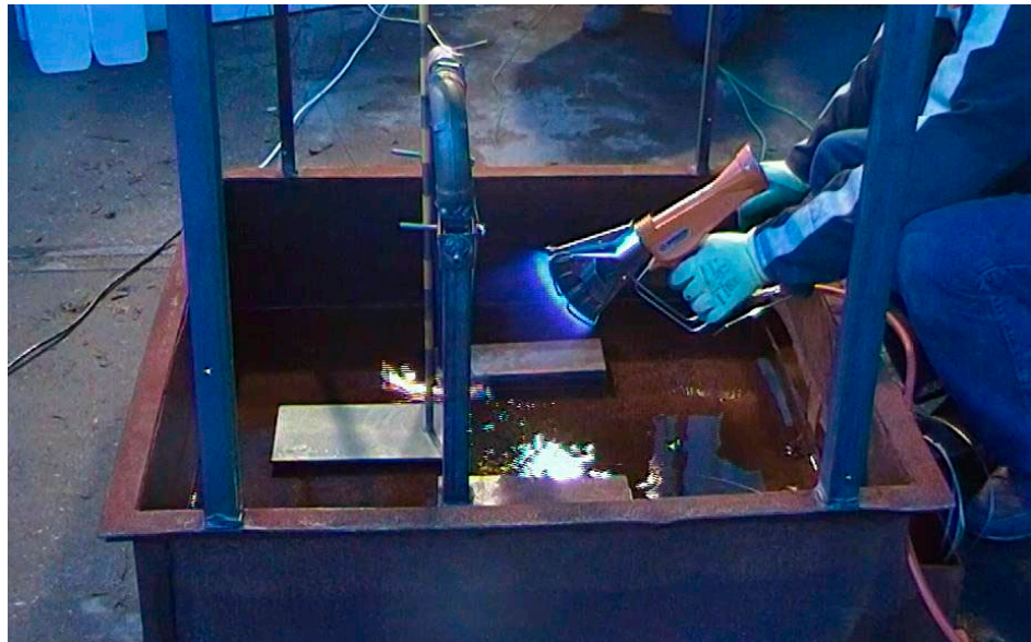
Figuur 11: Positie van de brander op het moment van ontsteking (test 7)
