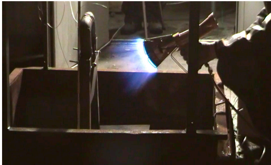
Figuur 5: Positie van de brander tijdens test 3
