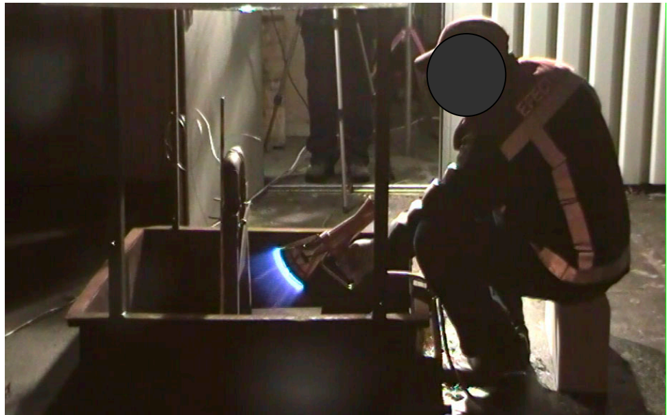
Figuur 6: Positie van de brander juist voor het ontbranden van het xyleen (test 4)
