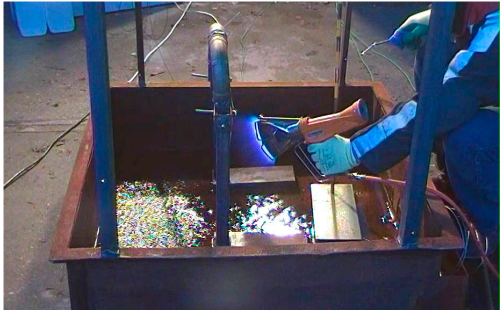
Figuur 10: Positie van de brander en persluchtmondstuk tijdens test 6.
