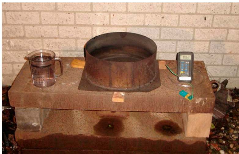
Figuur 2: Testopstelling voor verkenning ontsteekgedrag.
