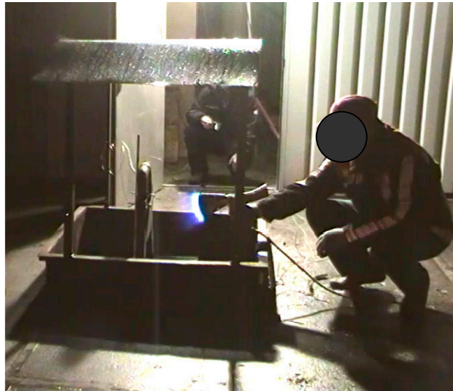
Figuur 4: Positie van de brander tijdens test 2
