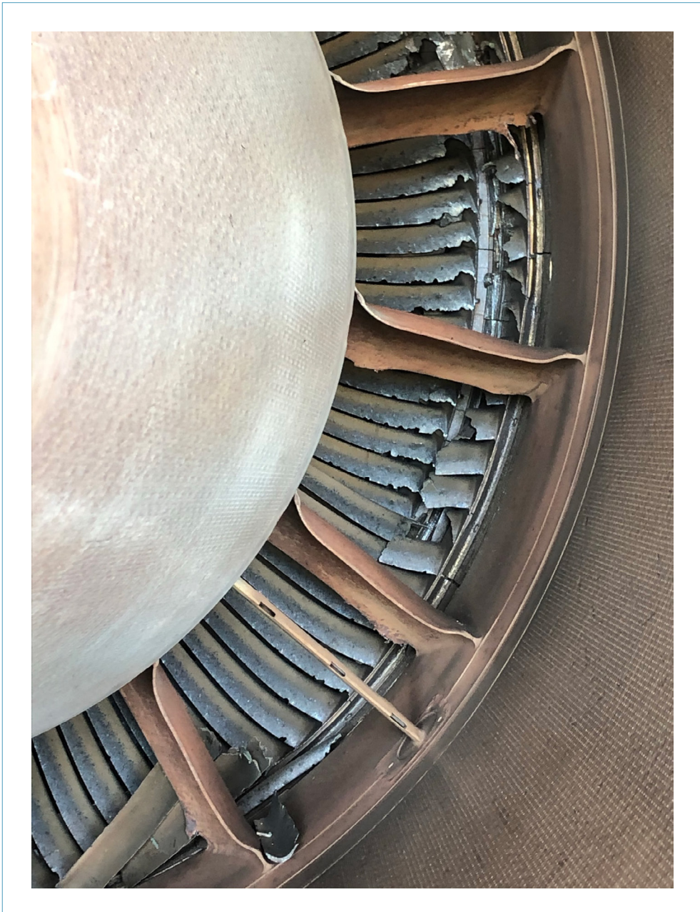
Figuur 3: Zichtbare schade aan lagedrukturbine, gezien vanaf de uitlaatzijde van de motor. (Bron: Onderzoeksraad voor Veiligheid)
