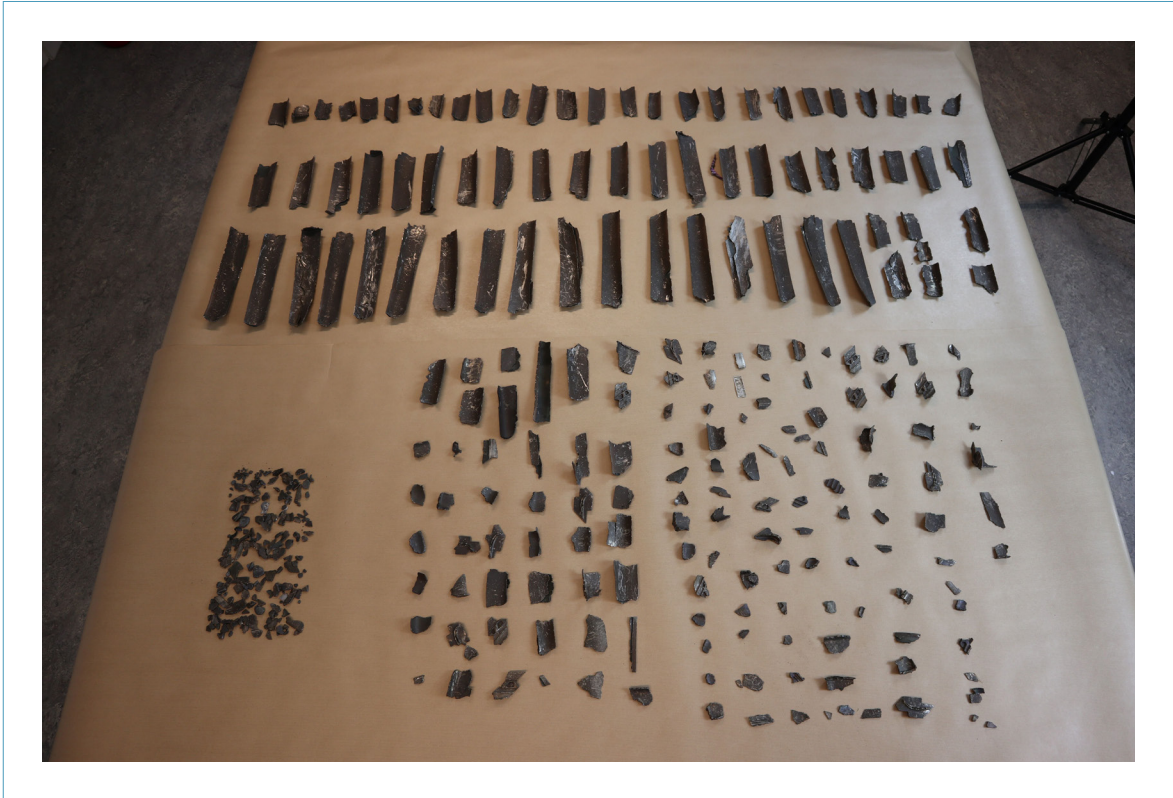
Figuur 7: Verzamelde turbinefragmenten. (Bron: Onderzoeksraad voor Veiligheid)
