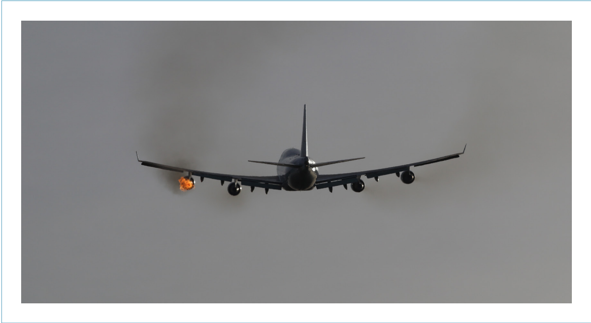
Figuur 1: Vlammen waargenomen na defect raken motor nummer 1. (Bron: Maastricht Aachen Airport)
