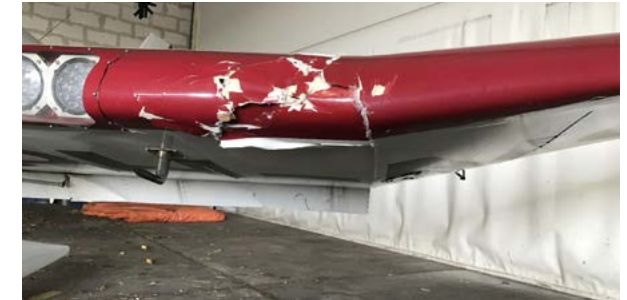
Schade aan de linkervleugel. (Bron: Politie, Team Luchtvaarttoezicht)
