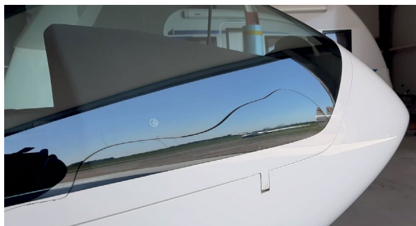
De beschadigde cockpitkap van de Discus bT. (Bron: Piloot)
