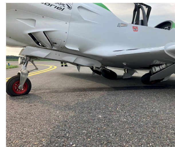
Het ingeklapte landingsgestel. (Bron: Lelystad Airport)
