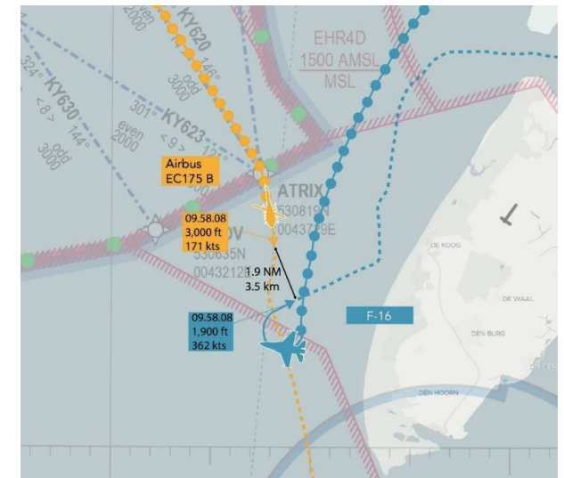
De airprox tussen de F-16 en de helikopter vlakbij waypoint ATRIX, op basis van radargegevens. De genoemde hoogtes zijn uitgedrukt in QNH. (Bron grafiek: AIS the Netherlands en-route chart ICAO, bron achtergrondkaart: OpenStreetMap)
