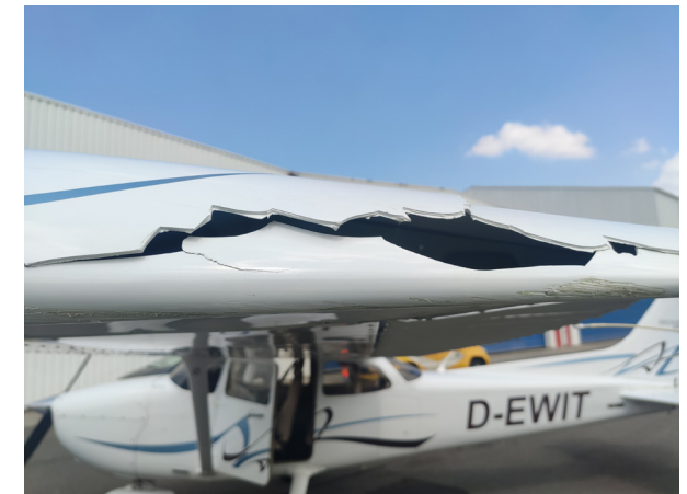
Schade aan de linkervleugel. (Bron: Havendienst Rotterdam The Hague Airport)
