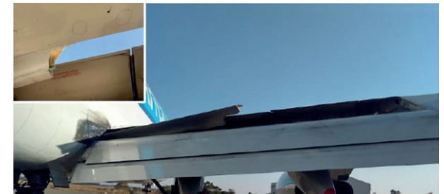
De rechtervleugel met de beschadigde inboard flap. (Bron: Betrokken luchtvaartmaatschappij)
