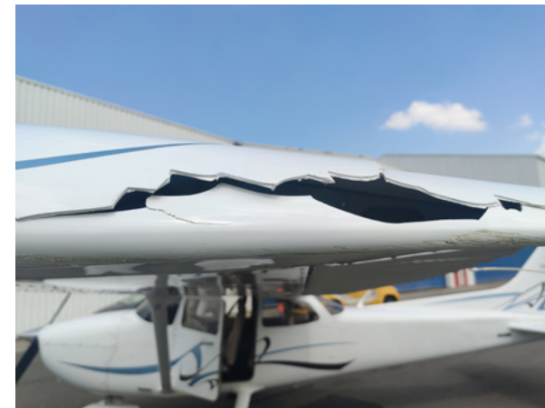
Schade aan de linkervleugel. (Bron: Havendienst Rotterdam The Hague Airport)
