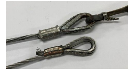
Boven: correct kabeloog. Onder: Foutief kabeloog aan het andere eind van de gebroken kabel.
