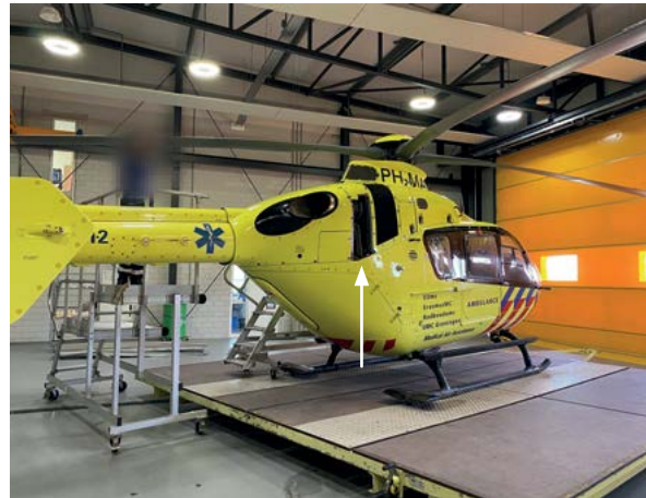
De helikopter met het verloren motorinspectieluik. (Bron: ANWB MAA)
