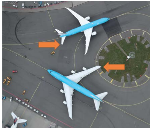
De positie van de vliegtuigen na de botsing. De pijlen geven de beschadigde vliegtuigonderdelen aan. (Bron: Politie, Team Luchtvaarttoezicht)
