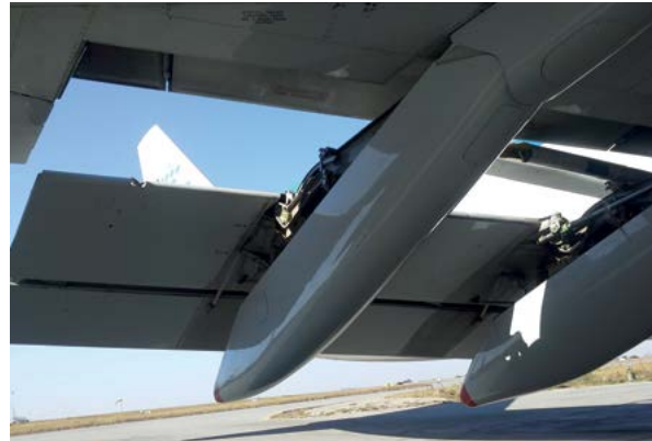
Afgebroken deel van de inboard foreflap . (Bron: eigenaar vliegtuig)
