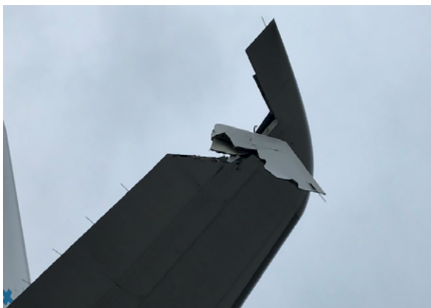
Het beschadigde stabilo. (Bron: AAS)
