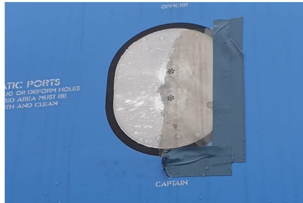
Niet verwijderde afdekking. (Bron: luchtvaartmaatschappij)
