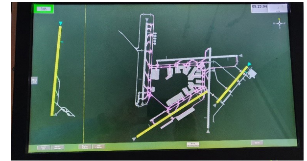
Het Airfield Lighting Control and Monitoring System (ALCMS) bedieningspaneel van de luchthaven Schiphol. De geel verlichte banen zijn beschikbaar gesteld aan de luchtverkeersleiding, de grijsgekleurde niet.
