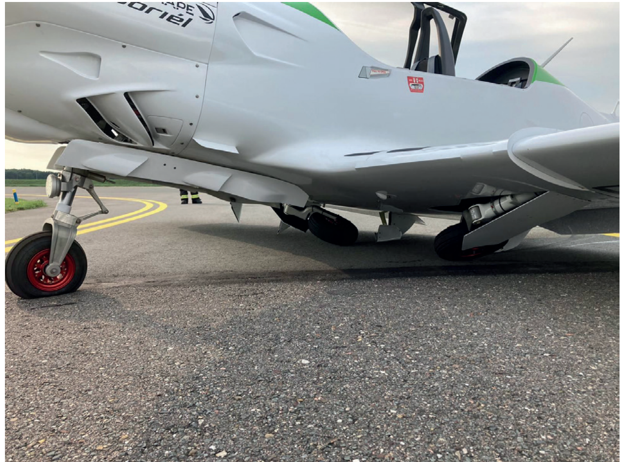
Het ingeklapte landingsgestel. (Bron: Lelystad Airport)
