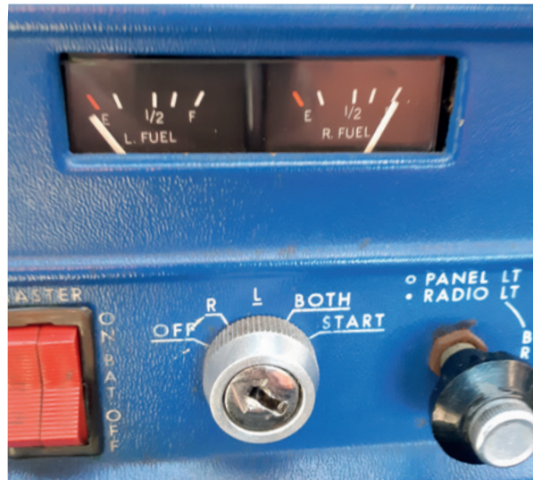
De brandstofmeters enige tijd na de noodlanding. (Bron: Politie, Team luchtvaarttoezicht)
