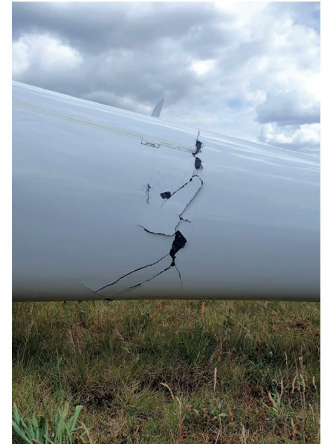
Schade aan de romp. (Bron: Piloot)
