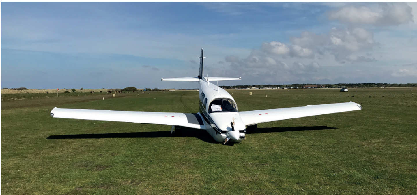
De Mooney met het ingeklapte neuswiel. (Bron: Politie, Team luchtvaarttoezicht)
