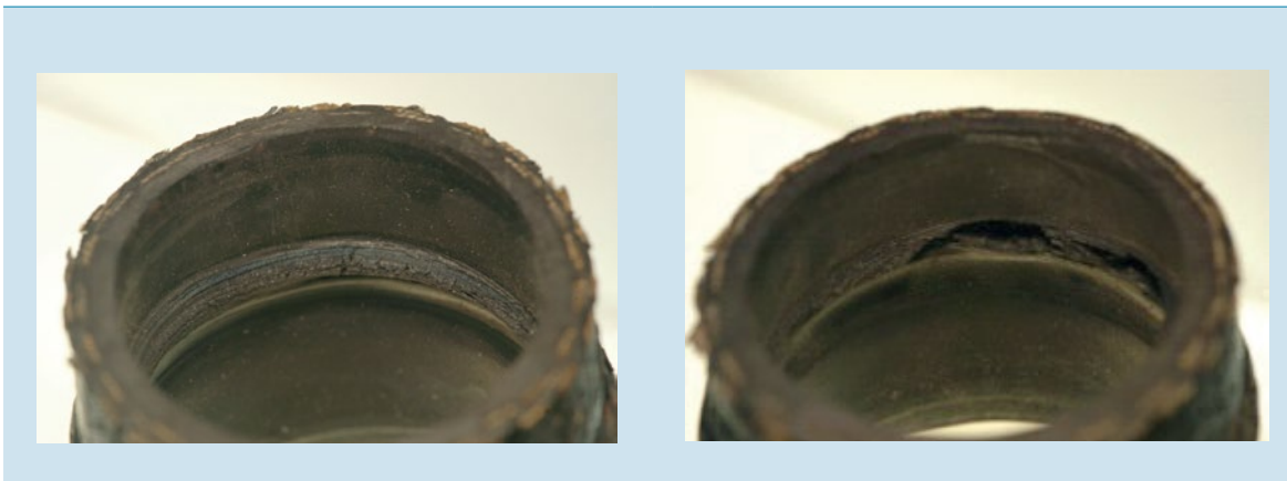
Figuur 8: Slang met ribbel, deels onbeschadigd (links) en beschadigd (rechts). (Bron: Onderzoeksraad voor Veiligheid )
