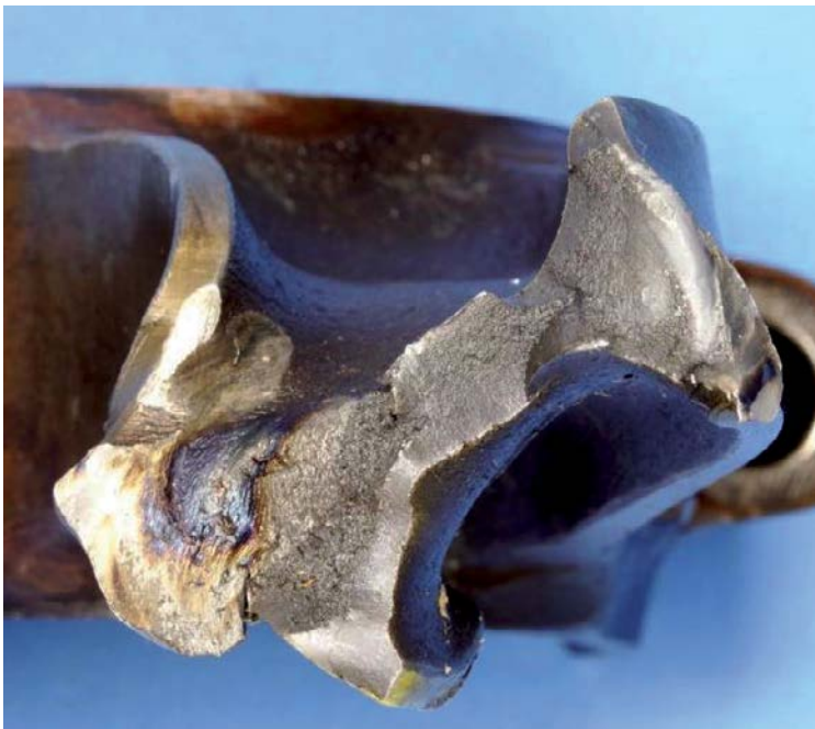
Figuur 5: Breukvlak van de nummer 5 drijfstang. (Bron: NTSB)
