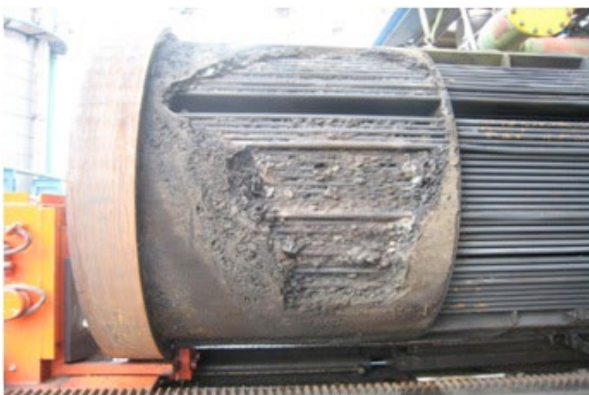
Figuur 2: Foto van vervuilde pijpenbundel in koeler H304B. (Bron: SABIC "Presentatie Fouling H304 tbv bezoek PROV op 25-09-2013 Final")
