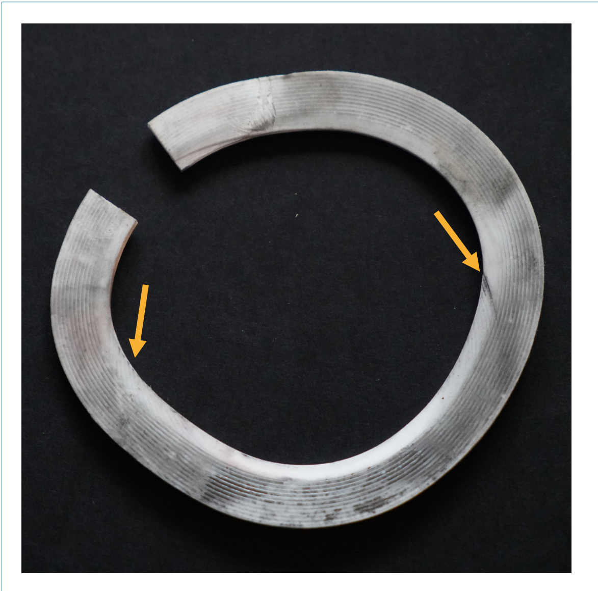
Figuur 9: De bezweken pakking. Zichtbaar is de zijde met twee sets afdrucken afkomstig van de groeven van het flensprofiel. De tweede set afdrucken is zichtbaar op het deel van de pakking tussen de twee pijlen. (Bron: ILT)
